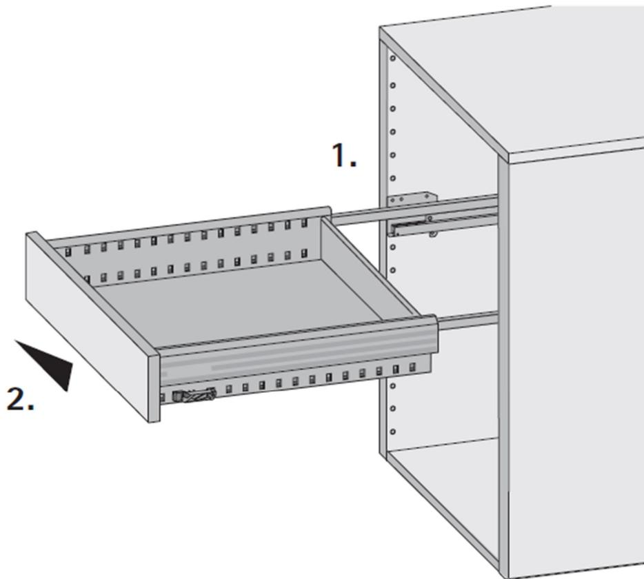
1. Auszugführungen komplett ausfahren und den Stahlschubkasten auf diese legen.
