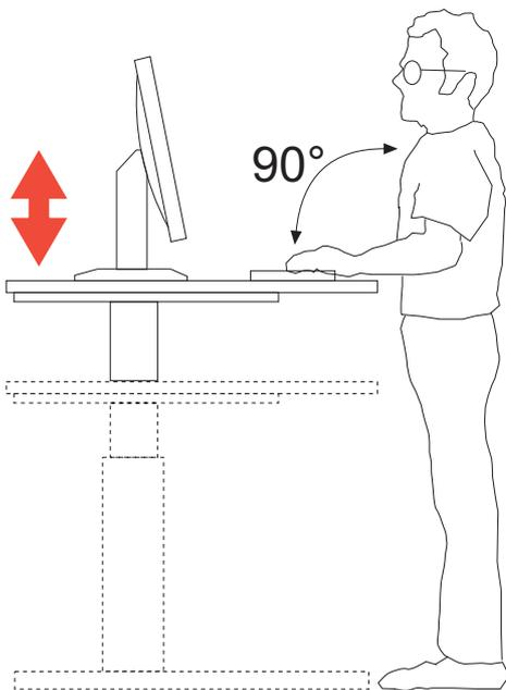
Achten Sie bei der optimalen Stehhöhe darauf, dass Unter- und Oberarm einen  $90^\circ$  Winkel ergeben.
