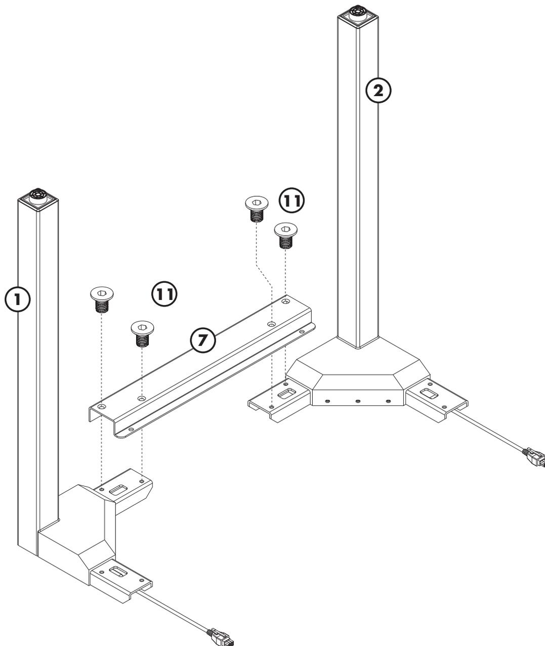
Der Tisch kann mithilfe von 200mm langen Distanzstücken in der Tischbreite erweitert werden. Somit können 4 Tischbreiten realisiert werden.
