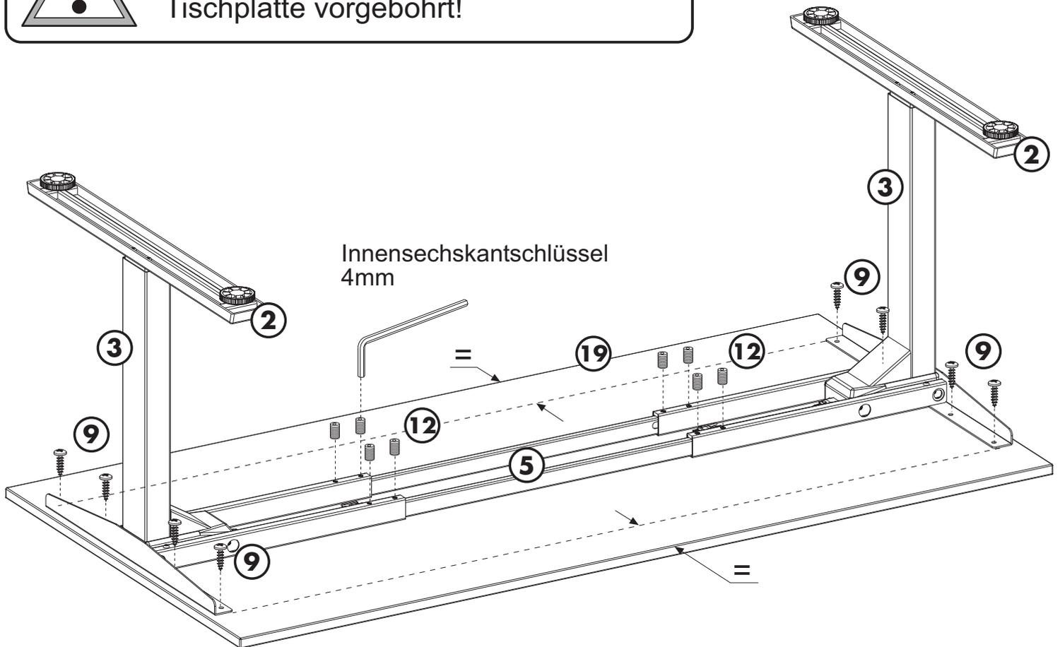
Der Oberrahmen des Schreibtischgestells ist in der Breite stufenlos teleskopierbar, in den Abmessungen 1200 -1800mm. Daher ist dieser Oberrahmen für Tischplattenabmessungen von:
