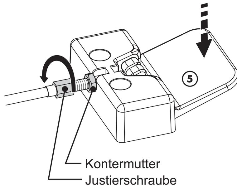
Die Justierschraube im Gegenuhrzeigersinn solange drehen, bis der Bowdenzug auf Spannung kommt und durch Drücken des Betätigers die Gasfeder auslöst. Drehung im Uhrzeigersinn bewirkt ein weniger sensibles Auslösen der Gasfeder.
