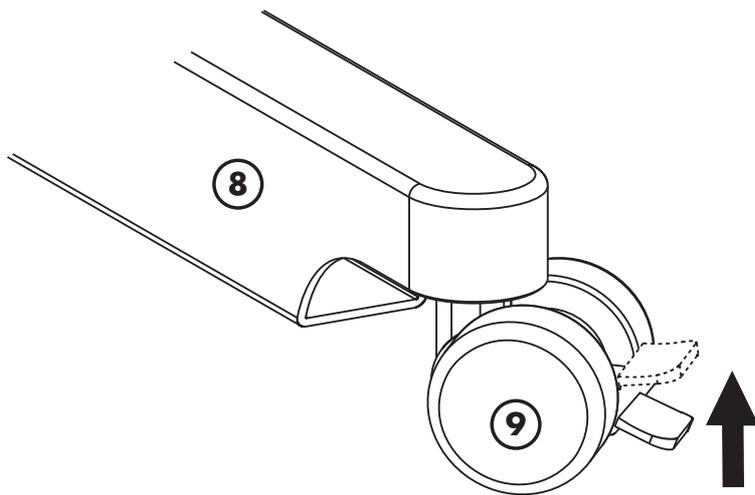
Bremse an Bodenrolle lösen
